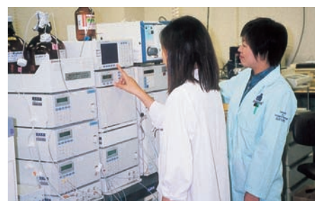
高速液体クロマトグラフ装置を用いたビタミンや指定食品成分等の分離・定量
