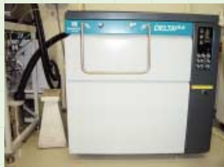
安定同位体比を測定する質量比分析計
