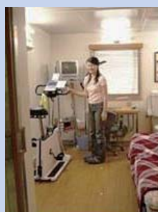
ヒューマンカロリメーターによる エネルギーの測定 (2000年)
