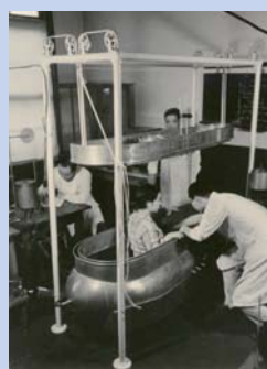
ヒューマンカロリメーター によるエネルギーの測定 (1922年頃)
