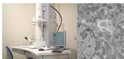
透過型電子顕微鏡 日立(H7650)
