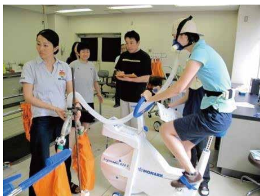
自転車エルゴメーターを用いた最大酸素摂取量の測定
