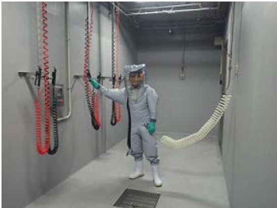
スーツタイプ防護服 (薬液シャワー室)
